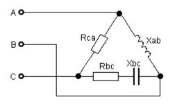
Реактивная мощность Q трехфазного потребителя, сопротивления фаз которого  $X_{ab} = R_{bc} = R_{ca} = 12$  Ом;  $X_{bc} = 16$  Ом, а линейное напряжение  $U_{\pi} = 660$  В, равна:
