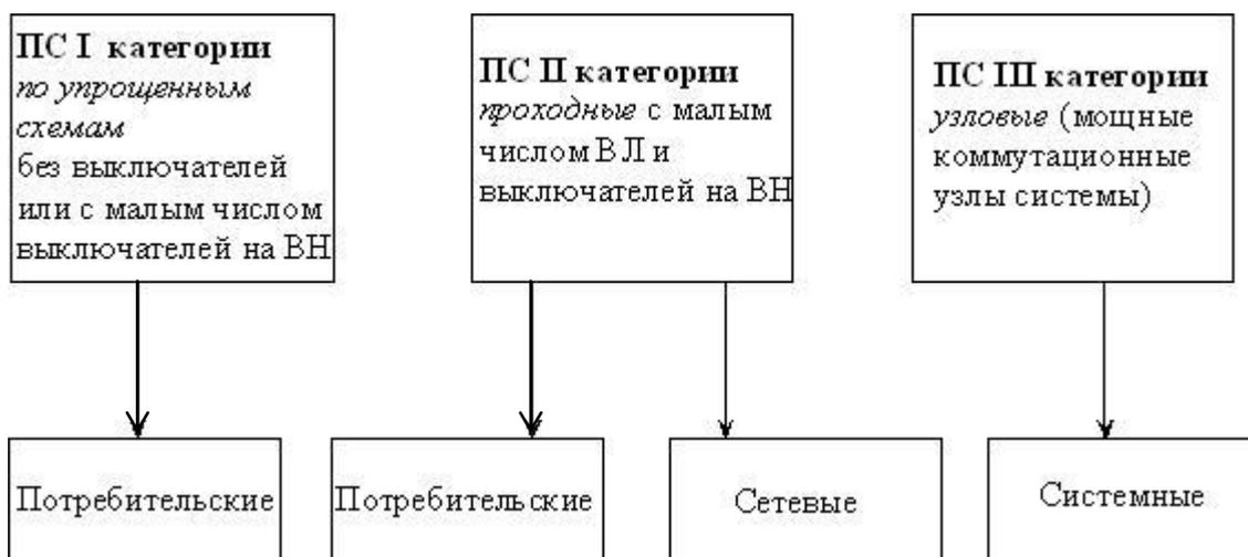
Рисунок 6.1- Структурные схемы подстанций
