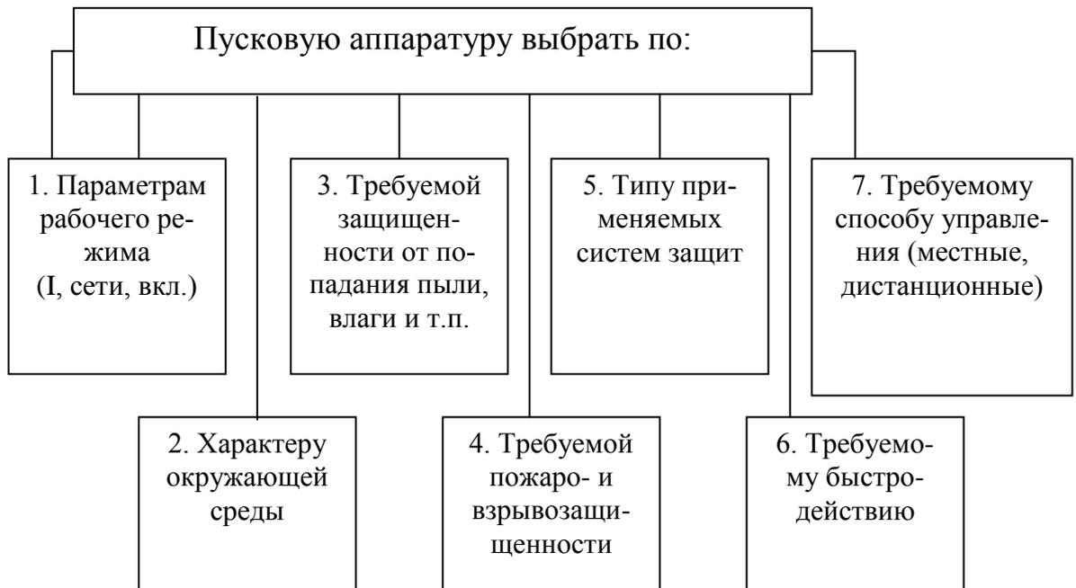
Рис. 3.3. Алгоритм выбора пусковой аппаратуры
