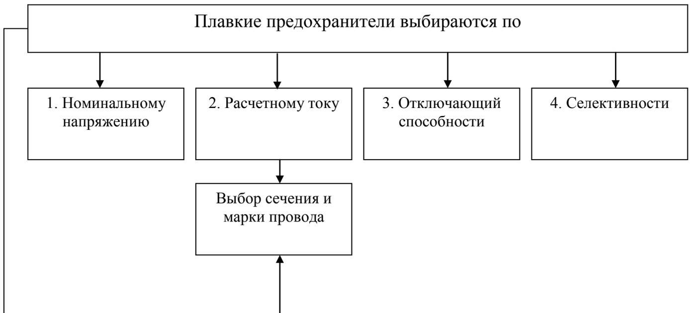
Алгоритм выбора плавких предохранителей и сечения провода.
