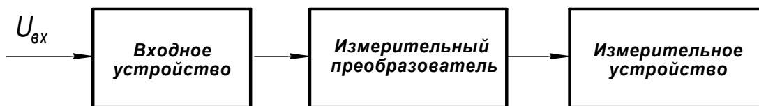
Рисунок 14- Структурная схема аналогового электронного вольтметра
