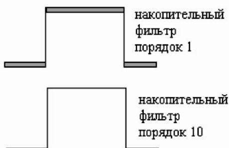
Рисунок 8 - Осциллограммы прямоугольного импульса с высокочастотной помехой без включения накопительного фильтра и с включенным накопительным фильтром порядка 10
