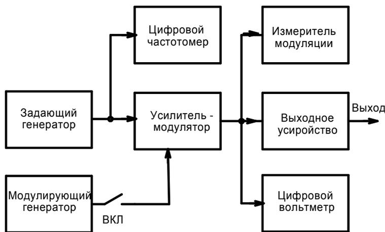
Рисунок 1 - Структурная схема генератора высокой частоты
