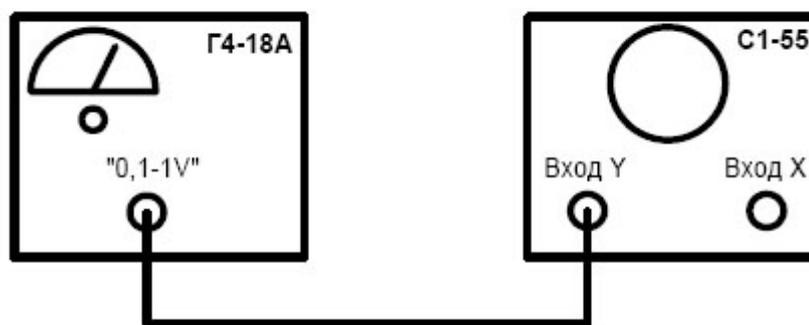
Рисунок 5 - Схема измерение коэффициента амплитудной модуляции
