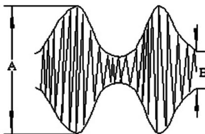
Рисунок 3 - Осциллограмма модулированных колебаний
