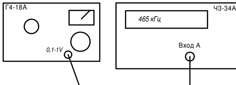
Рисунок 4 - Схема измерения частоты выходного сигнала генератора цифровым частотомером.
