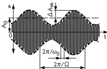
Рисунок 2 - Параметры модулированного сигнала
