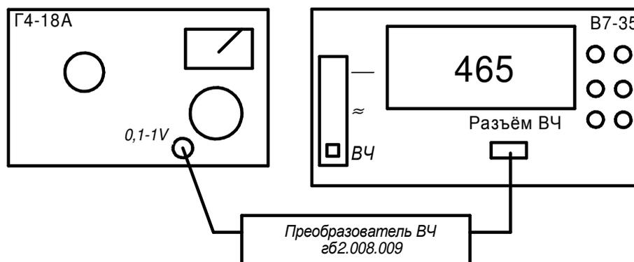
Рисунок 3 - Схема измерения напряжения на выходе генератора высокой частоты цифровым вольтметром
